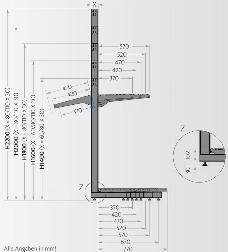
Die Grafiken zeigen, in welchen Höhen und Tiefen die Systemelemente erhältlich sind. Die Bandbreite der unterschiedlich dimensionierten Stützen und Träger von **HK25** steht für höchste Variabilität.
